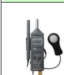
E' opportuno svolgere un'analisi quantitativa effettuando delle misurazioni dell'entità della luce che investe una certa superficie utilizzando il luxmetro, strumento per la misura del livello di illuminamento espresso in lux. Questa semplice analisi può fornire indicazioni interessanti sul comfort luminoso e sull'efficienza del sistema di illuminazione.
