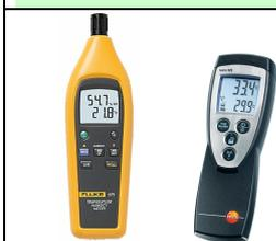
La valutazione precisa della temperatura è ovviamente il primo parametro oggetto di analisi. Il termometro a contatto indica la temperatura di una superficie, e, con sonde opportune, l'interno dei materiali. Il termo-igrometro ambientale permette di rilevare, con precisione e velocità, la temperatura ambientale interna / esterna e l'umidità relativa, parametri di fondamentale importanza e basilari per le successive analisi.
