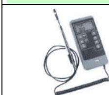
L'anemometro è uno strumento utilizzato per misurare la velocità dell'aria. In campo termo-acustico, l'utilizzo dell'anemometro è fondamentale per rilevare il passaggio di aria da piccole fessure tra gli elementi strutturali fissi e mobili; inoltre, permette di verificare l'efficienza degli impianti di condizionamento a flusso di aria forzato e di quantificare volumetricamente le perdite di aria condizionata dagli edifici.
