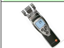
L'igrometro è uno strumento in grado di misurare, in modo rapido e non distruttivo, l'umidità nei materiali edili.
